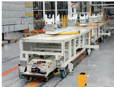
潜り込み牽引
